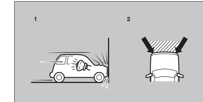
1-以大约25km / h或更高车速，迎面碰撞到实心墙壁上，安全气囊张开。
