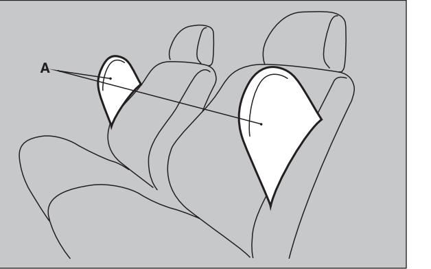
图示标签缝在带侧面安全气囊的座椅靠背上。
